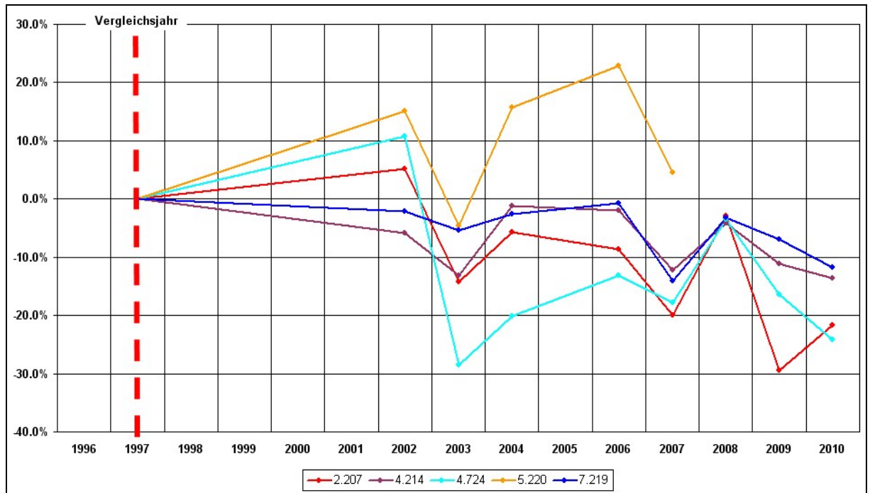
Abb. III.5.6.1.2-3: Prozentuale Entwicklung der Querschnittsflächen der Este in Bezug zum Zustand 1997 (Ist-Zustand der Beweissicherung für die Profilaufnahmen).
