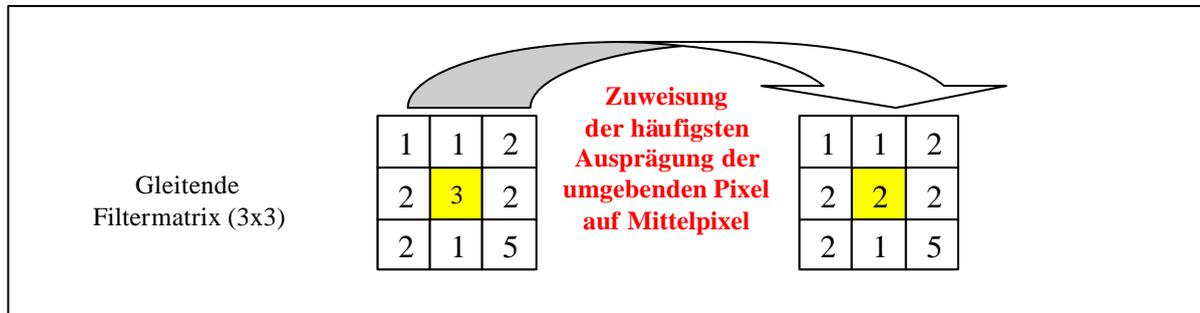
Abbildung 4-12 Funktionalität des Focal-Majority-Filters (Ehlers, M. et al., Vechta 2000)
