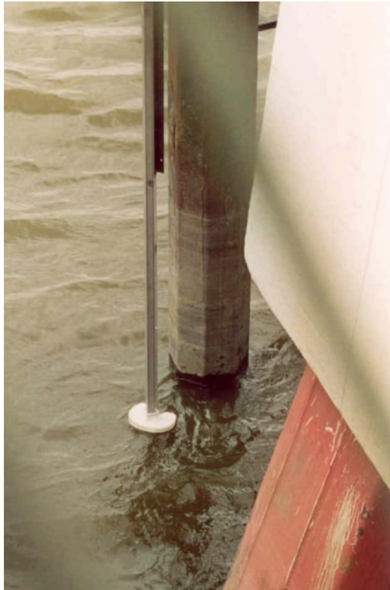
Abbildung 1 Messgerät mit Schwimmer neben einem Dalben
