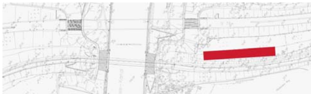
Phase 1: Montage auf Vormontageplatz parallel zum Baufeld
