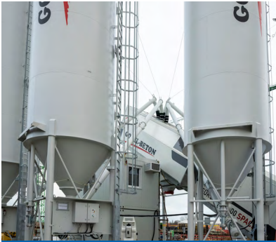
In den vertikalen Silos lagern verschiedene Zementsorten.
