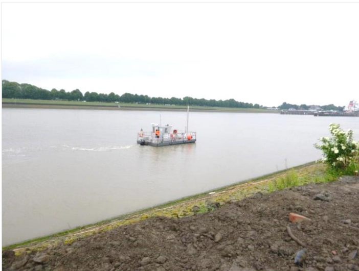
Der Schlick im elbseitigen Vorhafen wird geophysikalisch auf Anomalien sondiert.
