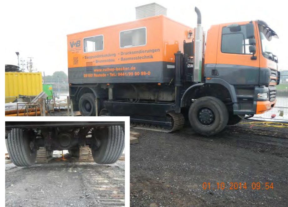
Abb. 6 Mit Drucksondierungen werden zusätzlich die Festigkeiten und Lagerungsdichten der Sande kontrolliert. Beim Sondieren wird ein Messkopf mit kegelförmiger Spitze über ein Gestänge in den Boden gedrückt. Gemessen wird der Spitzendruck und die Mantelreibung.
