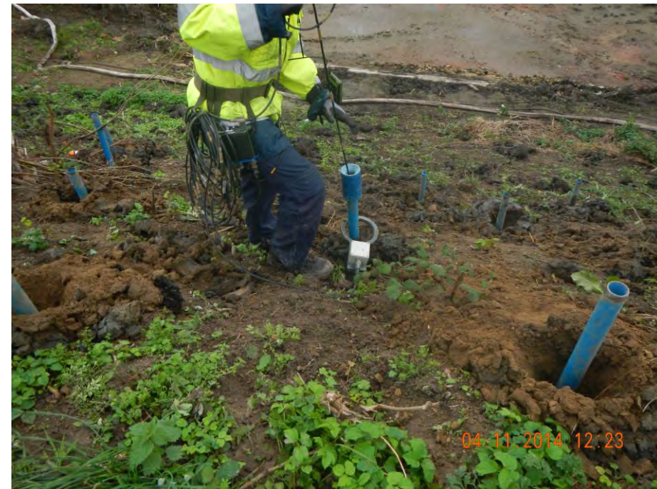
Abb. 12 Nach der Bohrlochsondierung werden die aufgenommenen geophysikalischen Daten ausgewertet und entweder die Freigabe des Kampfmittel-Verdachts erteilt oder die weitere Untersuchung georteter Störkörper durchgeführt.
