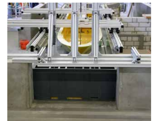
Abb. 3: Modell des neuen Schiebetors im Versuchsstand der BAW in Karlsruhe, Seeschiff der Verkehrsgruppe 6
