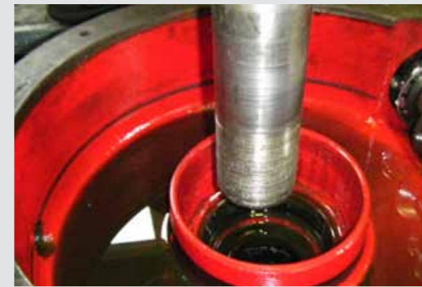
Abb. 3: Eingelaufene Welle eines Antriebes
