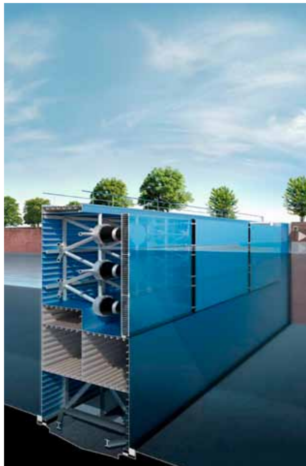
Abb. 5: Schiebetor neuer Bauart mit Fenderung
