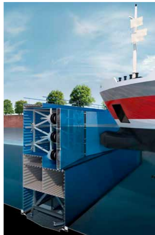
Abb. 6: Schiebetor neuer Bauart mit Fenderung
