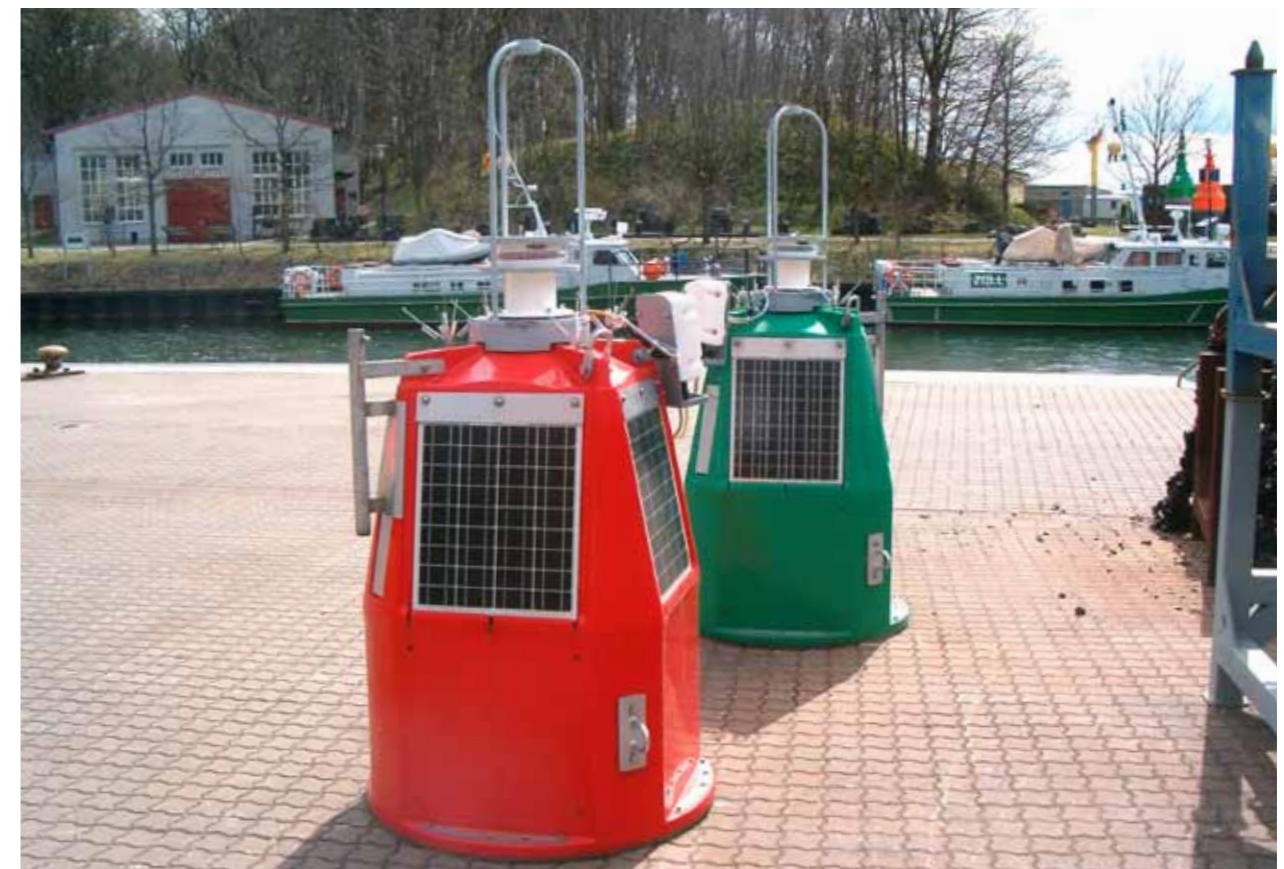
Abb. 1: Zwei Solarkompaktaufsätze mit Synchronisationsmodulen im Probetrieb auf dem Bauhof
